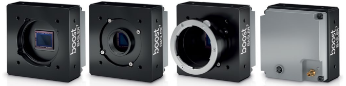
그림 1: Basler boost는 F-, C- 또는 M42 마운트 중 하나를 선택하여 사용할 수 있습니다. 동축 케이블은 마이크로 BNC 플러그를 통해 카메라에 연결되며 데이터 전송 및 전원 공급 장치에도 사용됩니다. 따라서 단 하나의 케이블만 필요하므로 케이블 라우팅 및 구성이 용이합니다.
