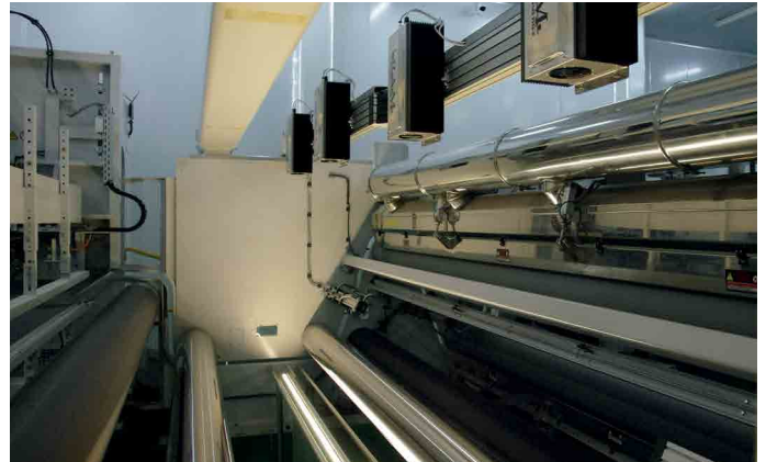
5.50m 대형 호일 분석을 위한 8K 카메라 4대가 탑재된 호일 검사 시스템
