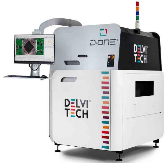
전자회로기판 조립 검사를 위한 AOI 이미지 처리 시스템 / 출처: Delvitech
