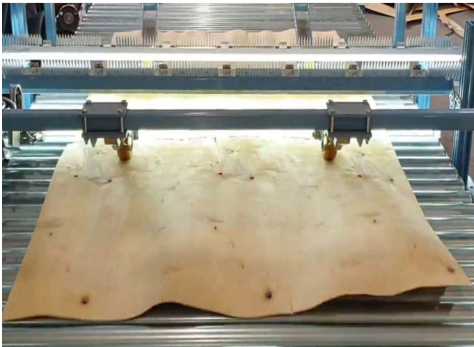
그림 1: 베니어판 등급 분류를 위한 시스템 설치
