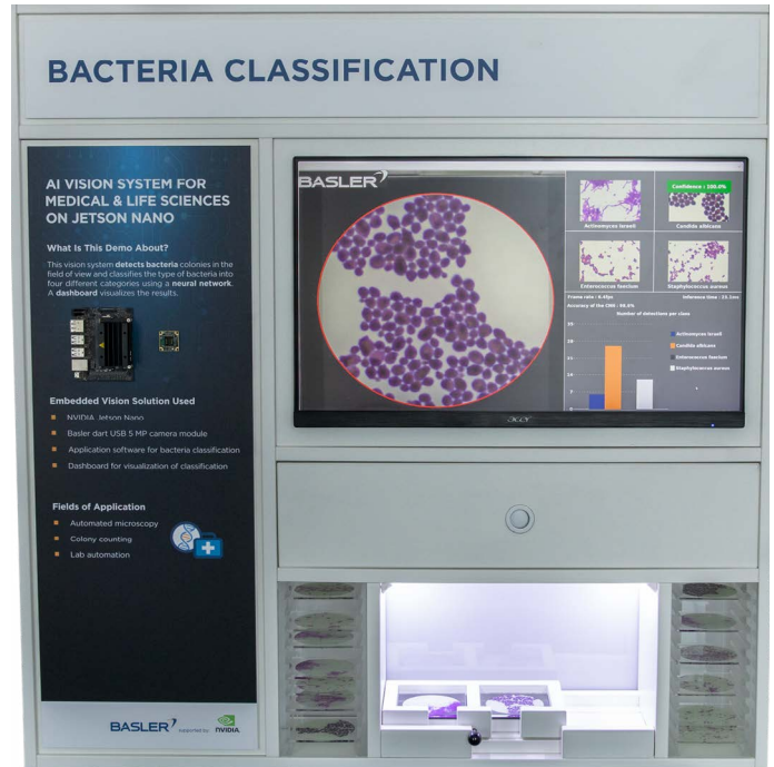
Basler dart 5 MP 카메라 모듈을 사용하여 AI 기반 박테리아 분류 작업을 수행하기 위한 데모 설정. 그림의 오른쪽 상단의 대시보드에 시각화된 결과가 표시됩니다.
