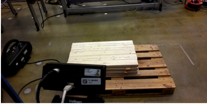
그림 1: 목재 창틀 부품 더미 위치를 감지하는 데 사용되는 Basler ToF 카메라
