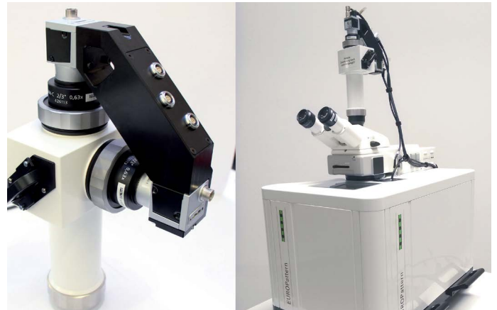
두 대의 Basler ace 카메라가 탑재된 자동 면역 형광 검사용 현미경 및 매트릭스 코드 기록 장치에 내장된 Basler dart 카메라.
