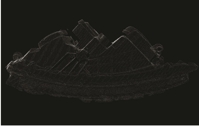
포인트 클라우드(point cloud) 데이터를 기반으로 재구성된 전조등의 3D 이미지
