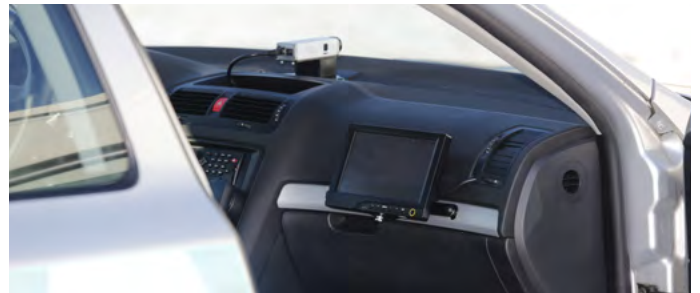
그림 3: 데시보드의 전방 카메라와 PC 제어용 터치스크린 디스플레이.
