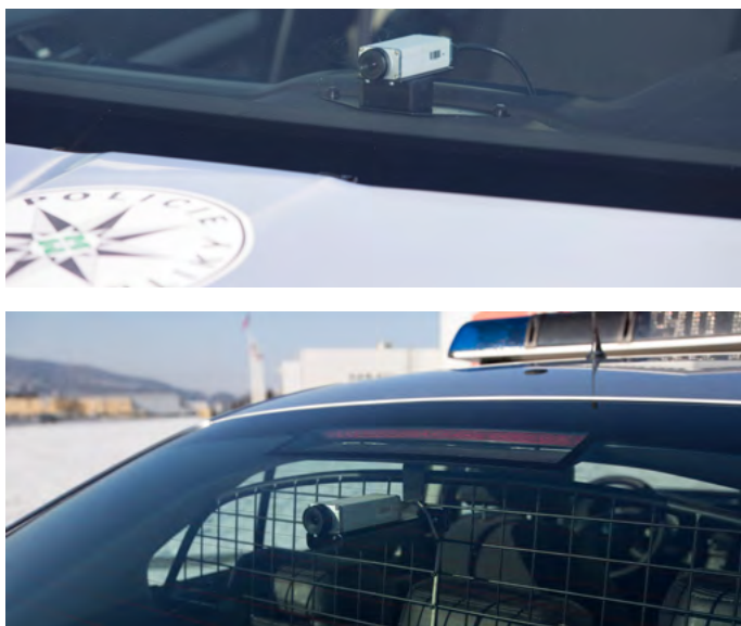
그림 1 및 2: 프로젝트 수행 대상 차량 대수는 1572대였으며 차량마다 전방과 후방에 비디오 카메라를 장착, 모두 3144대의 카메라를 장착해야 했습니다.
