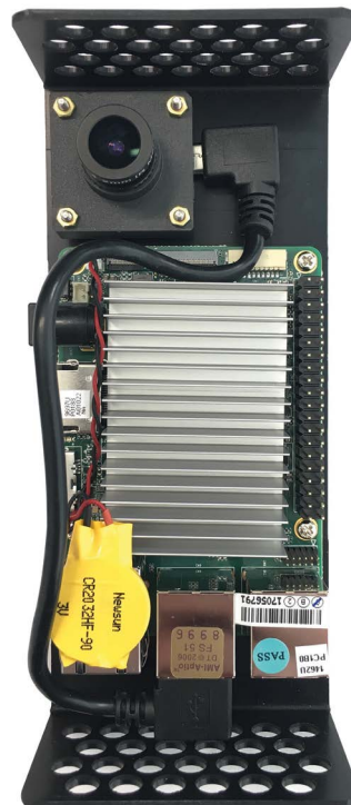
AAEON UP Board 및 Basler dart USB 3.0 카메라가 사용된 광학 Pysense Sensor 2의 내부
