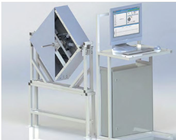
실린더 형태 제품의 지름 및 난형도의 지속적인 컨트롤을 위한 머신 비전 시스템
